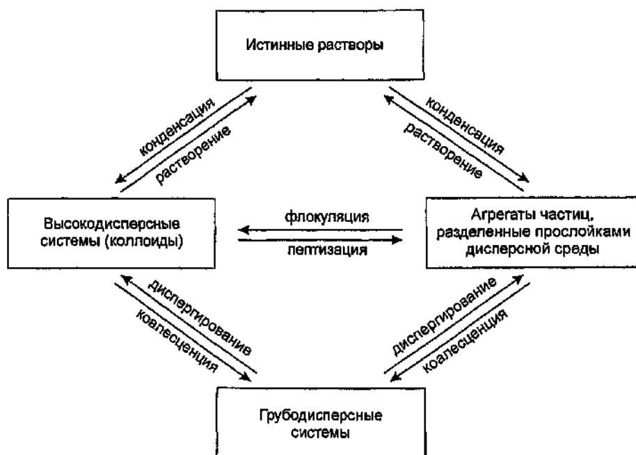
Рис.9.26. Схематическое изображение процессов, отражающих переходы одних типов дисперсных систем в другие
